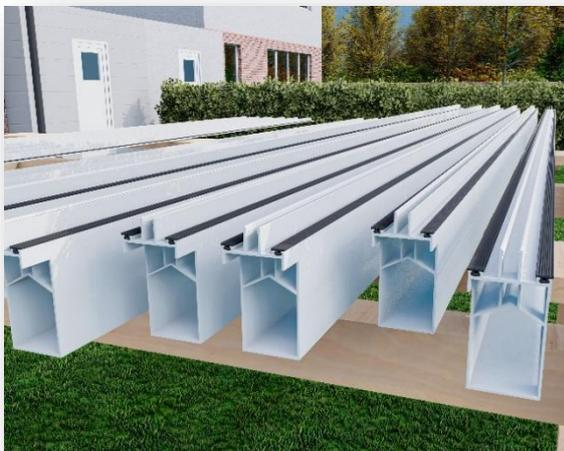
Als nächsten Schritt bereiten Sie die Träger, Klips und Endklips vor. Zuerst sollten Sie die Gummierung anbringen. Die Gummierung für die Klips ist die gleiche. Bei einer VSG-Glas gibt es zwei unterschiedliche Gummis. In diesem Fall wird die stärkere Gummi für dem Träger verwendet. Bei zwei Trägern die Außen liegen ist jeweils nur eine Seite einer Gummierung versehen. In den meisten Fällen haben wir diesen Arbeitsschritt für Sie übernommen.
