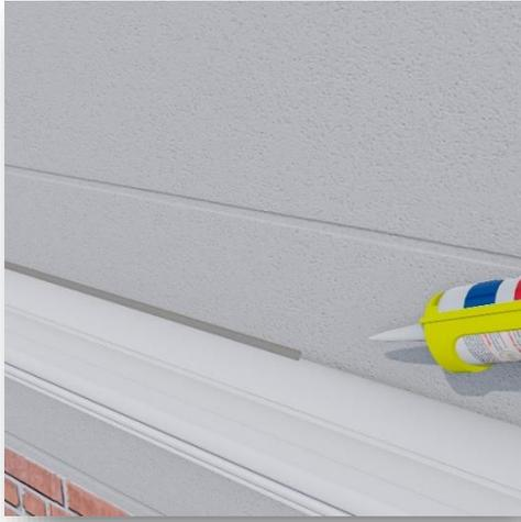
Das Kompriband gewährleistet eine dichte Verbindung zwischen Wandprofil und Hauswand. Jedoch ist bei unebener Hauswand das Auftragen von Silikon empfehlenswert.
