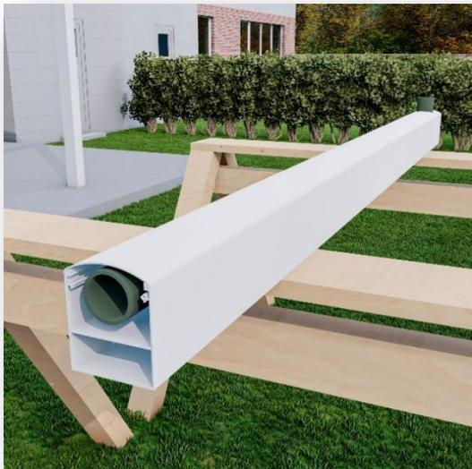
Wenn Ihre Rinne exakt waagrecht ist und die Maße korrekt genommen wurden, sollte der Pfosten mit der integrierten Rinne um 1-2 cm gekürzt sein, um eine leichte Neigung in Richtung des Fallrohrs zu gewährleisten. Bringen Sie das Fallrohr und die Umlenkung bereits im Freien in den Pfosten ein. Das Fallrohr sollte ebenfalls auf die benötigte Länge geschnitten werden, bevor es eingeführt wird. Es sollte etwa 2 cm kürzer sein als die Oberkante des Pfostens.
