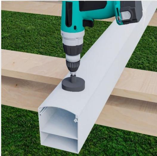
Bei dem Pfosten, an dem das Fallrohr integriert ist, benötigen Sie eine Öffnung für die Umlenkung des Wassers. Die Position und Höhe dieser Öffnung können Sie frei wählen. Normalerweise wird sie etwa 15 cm vom Boden entfernt nach vorne hin platziert.
