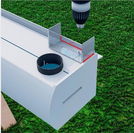
Die Pfosten werden mit einem U-Profil an der Rinne befestigt. Bringen Sie die U-Profile an der Stelle an, wo die Pfosten später platziert werden. Eine dünne Scheibe vom Pfosten kann zur Positionierung verwendet werden. Diese Pfosten werden ohnehin in einer Überlänge von 2500 mm geliefert.
