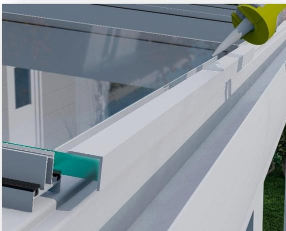
Für eine ästhetisch ansprechende Optik empfehlen wir bei der Verwendung von VSG-Glas als Dacheindeckung die Anbringung eines L-Profiles als Tropfnase, welches mithilfe von Silikon befestigt wird.
