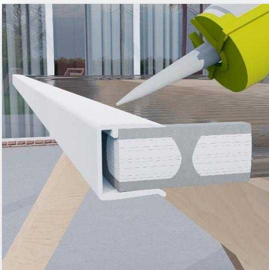
Die Stegplatten haben einen Hohlraum, um zu verhindern, dass Insekten in diesen Hohlraum gelangen, wird eine Seite der Stegplatte vollständig mit einem dichten Band verschlossen. Die andere Seite, die später an der Rinnenseite liegen wird, wird mit einem Antidust-Tape mit Mikro löchern versehen. Zur Gewährleistung der Trockenheit des Tapes wird dieses mit einem Profil und mit einer Silikon-Nase oben versehen, wodurch der Dunst rascher aufgelöst wird.
