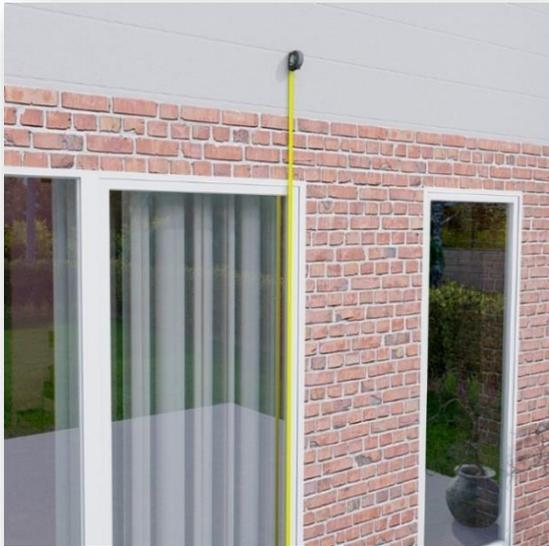
Installieren Sie das Wandprofil an der Außenwand Ihres Hauses, empfohlen wird dabei die Höhe der Zwischendecke (wenn möglich). Hier wird in den meisten Fällen die beste Stabilität erreicht. Beachten Sie bitte, dass die Terrassenüberdachung einen festen Neigungswinkel von 7 Grad vorgibt, was ungefähr 12 cm Höhenabfall pro Meter bedeutet. Bei einem 4m tiefen System bedeutet dies, dass wenn Sie an der Hauswand 2,50m Höhe wählen, die vordere Durchgangsöffnung ungefähr bei 2m liegen wird.
