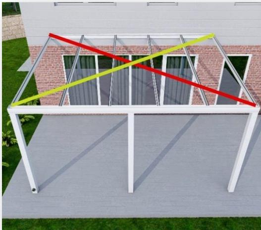
Eine präzisere Möglichkeit, um einen 90-Grad-Winkel zu messen, ist die Diagonalmessung. Dazu messen Sie die Entfernung zwischen den gegenüberliegenden Ecken der Überdachung. Legen Sie das Maßband diagonal von einer Ecke zur gegenüberliegenden Ecke, so dass es über die Fläche verläuft. Die gemessene Entfernung sollte auf beiden Seiten gleich sein und den 90-Grad-Winkel bestätigen.
