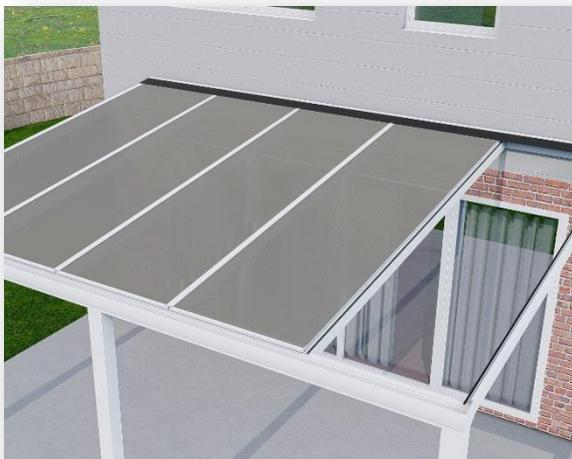
Bei der Installation ist es wichtig zu beachten, dass die Eindeckung auf der Hauswandseite unterhalb der Gumminippel des Wandprofils positioniert wird und etwa 3-5 cm über den Trägerprofilen in Richtung des Rinnenbereichs herausragt. Dadurch wird eine zuverlässige Ableitung von Regenwasser gewährleistet.
