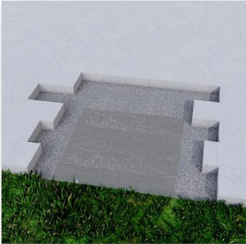
Die Fundamente für die vorderen Pfosten sollten bereits zu diesem Zeitpunkt vorhanden sein. Die Abmessungen sollten ungefähr 40x40x40 sein.
