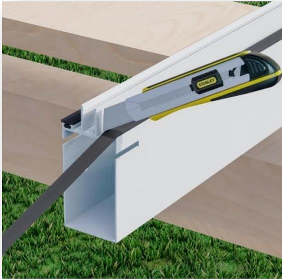
Die Gummierung, die als Auflagefläche für die Eindeckung vorgesehen ist, sollte in der Länge der Träger zugeschnitten werden.
